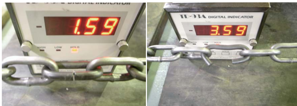
※実際に引っ張って見ましたら、約160kgで変形が始まり、約360kgで口が開きました。
